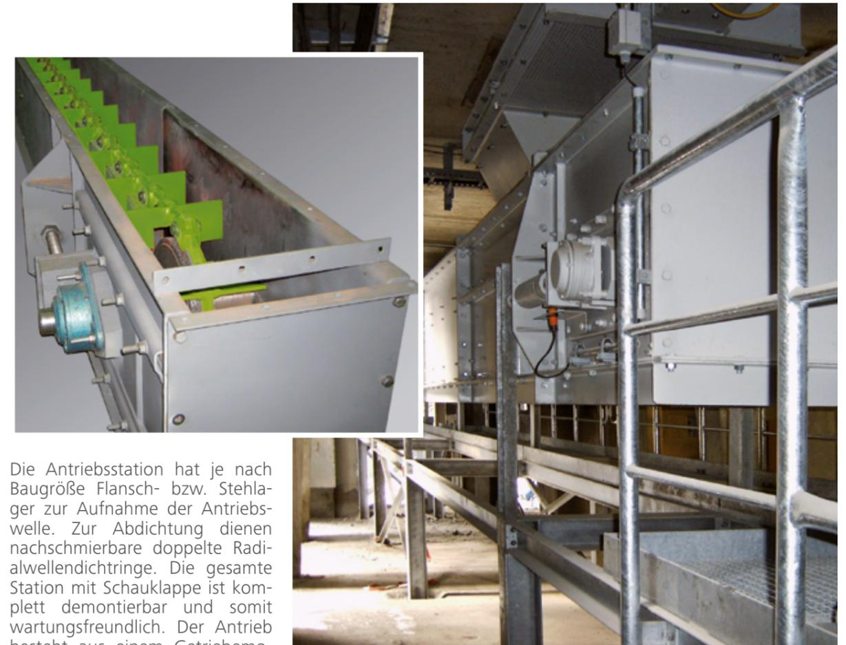
Die Antriebsstation hat je nach Baugröße Flansch- bzw. Stehlagler zur Aufnahme der Antriebswelle. Zur Abdichtung dienen nachschmierbare doppelte Radialwellendichtringe. Die gesamte Station mit Schauklappe ist komplett demontierbar und somit wartungsfreundlich. Der Antrieb besteht aus einem Getriebemotor oder einer Getriebe-Normmotor-Einheit auf seitlich angeordneter Konsole. Zur Vermeidung von Überlasten können entsprechende Sicherheitskupplungen vorgesehen werden.
