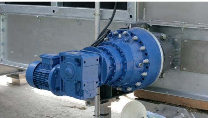
Hohes Drehmoment durch Planetengetriebe
